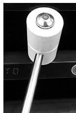
El extremo del botón de la sonda se coloca contra la placa que se está midiendo.
