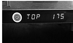
La placa superior está mostrando correctamente 175°F.
